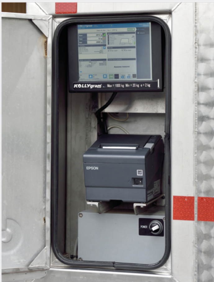
Onboard-PC mit 8"-Touchscreen (UTI) und Drucker
