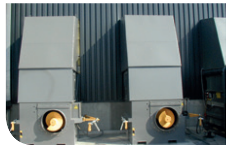
Compacteur à vis avec rails de centrage permettant de positionner précisément les conteneurs
