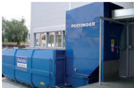
Compacteur à vis avec rails de centrage permettant de positionner précisément les conteneurs
