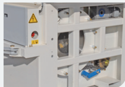
Entraînement protégé par joint à labyrinthe
